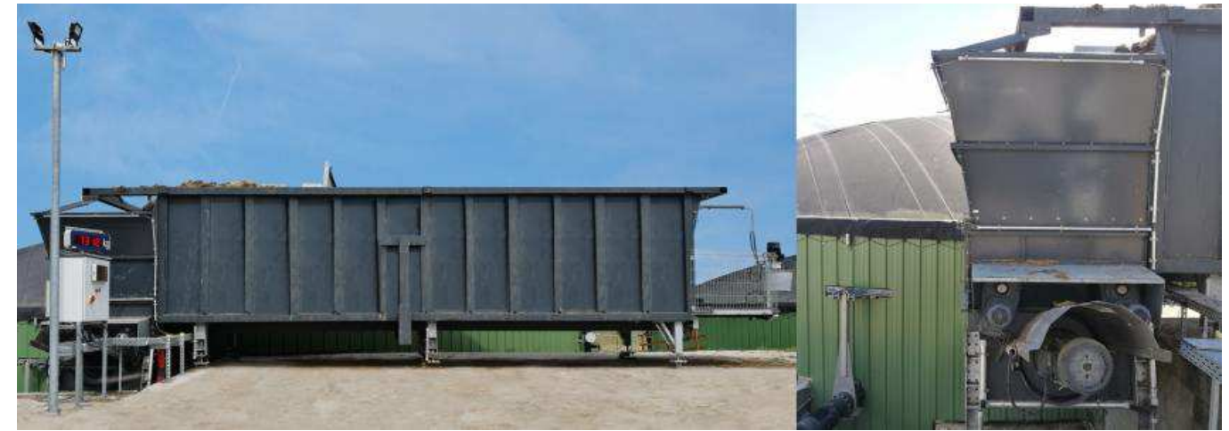
Figure 8 : Trémie d'incorporation (Source : Agrikomp)
